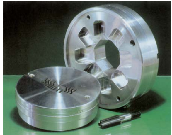
Têmpera a vácuo: matriz de extrusão, espina e ferramenta.
